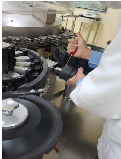
Figura 13: Ajuste de sincronía en rodillo de salida
